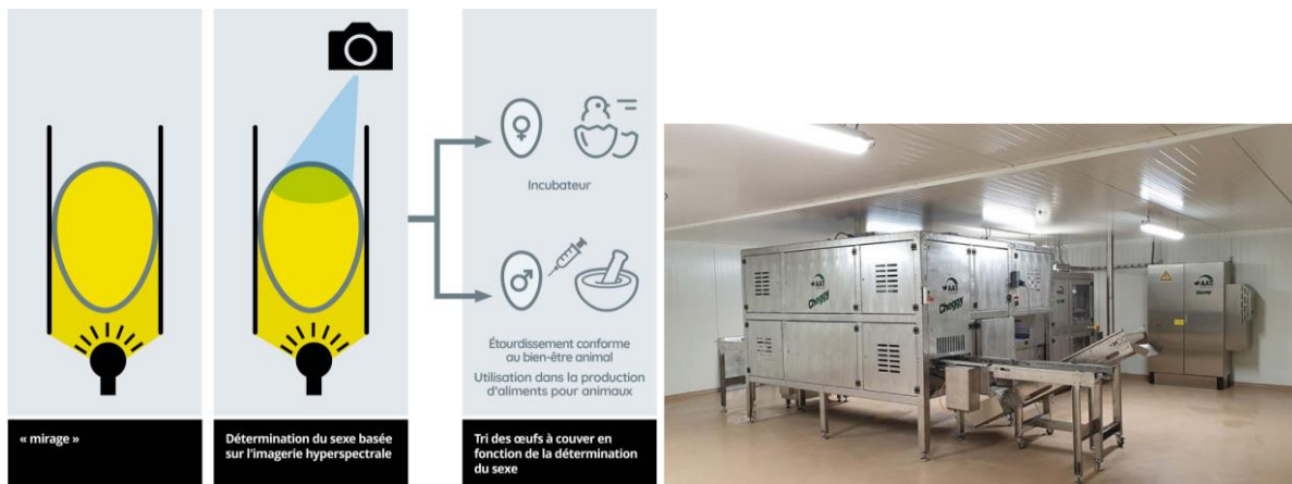
Ill. 9 et 10: Processus de technologie de mesure hyperspectrale, Dispositif technique Cheggy, https://www.agri-at.com/produkte/in-ovo-geschlechtsbestimmung/cheggy
