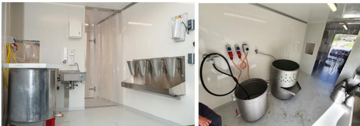
Fig.5.2. Intérieur d'une remorque équipée d'installations pour l'abattage de volailles https://www.mobile-schlachtung.at/
